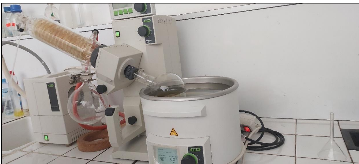
Figure 7. Évaporateur rotatif utilisé pour la concentration de l'extrait
